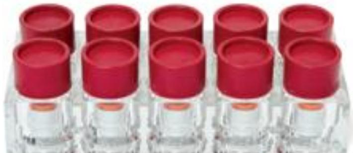
**VÉRIFIER L'ÉTALONNAGE DE VOS CAPTEURS :** Les unités **EasyCare CalCheck®**, sont utilisées pour étalonner vos capteurs **Rapid RH® Smart Sensor**. Les normes de contrôle ASTM F2170 préconise de vérifier l'étalonnage du capteur, 30 jours après utilisation.
