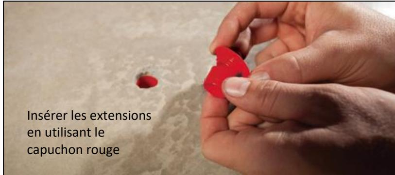
Le capteur intelligent **Smart Sensor** et/ou le baril/base mesure 1.6" de long ou 40% d'une dalle de béton ayant 4" d'épaisseur. La norme ASTM F2170-11, Section 10.2 spécifie : "Les dalles séchant par la partie supérieure uniquement (exemple : dalle au sol avec un coupe-vapeur au fond, ou dalle sur un tablier de métal): profondeur : 40%. Les dalles séchant de haut en bas (exemple: dalle sur une structure surélevée sans tablier de métal) : profondeur : 20%."
