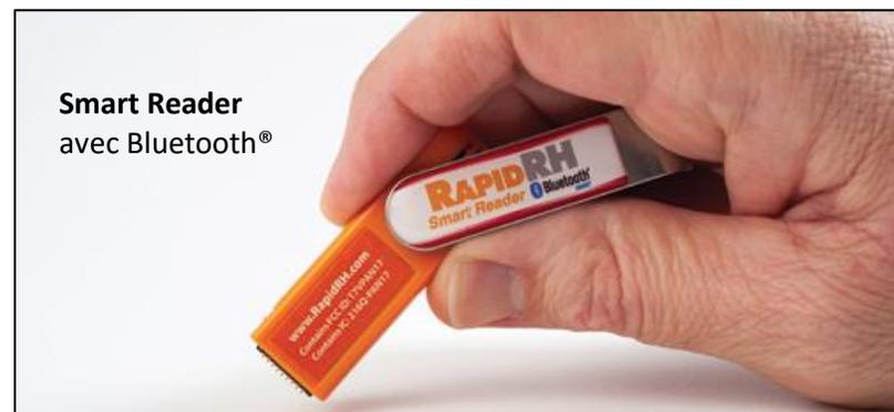
Le concept breveté fait que le **Rapid RH**® **Smart Sensor** s'équilibre plus rapidement que n'importe quel instrument de mesure d'humidité relative. Les projets requérant des décisions concernant les dalles de béton, sont habituellement prises une heure après l'installation. Ne pas oublier de suivre les procédures ASTM F2170 relatives à la durée d'équilibrage minimale pour rapporter des résultats de contrôle conformes.
