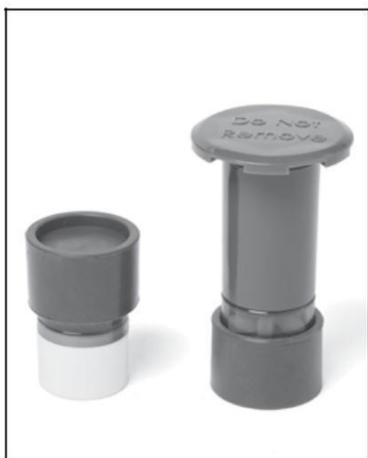
5. Joindre les deux cellules **EasyCare CalCheck®** et fermer avec le capuchon rouge en caoutchouc. Pour joindre la cellule supérieure et la cellule inférieure, serrer les deux cellules sans force excessive.
