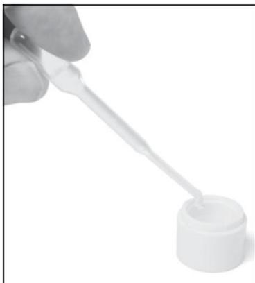
4. Ajouter le contenu de la pipette dans la cellule inférieure. Répéter pour un total de 3 coups d'eau à la cellule inférieure.
